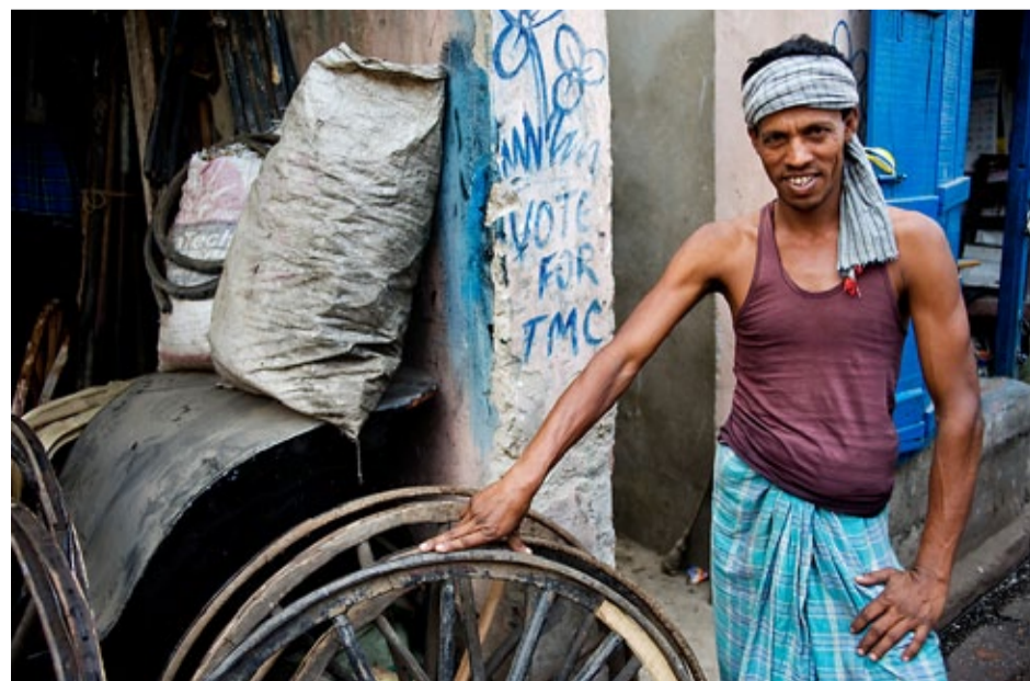
Hjulen består av ett järnnav med ett format hjul i trä som ett tunt gummidäck sedan är fäst på. Ibland saknas gummi och träet rullar då direkt på gatan.
