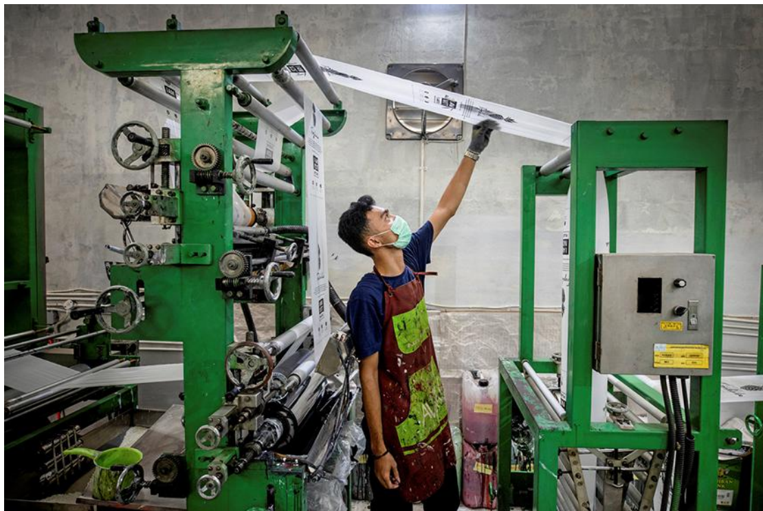
I Avani Ecos fabrik producerar man maniokstärkelse-baserade bioplastpåsar. Påsarna, som är komposterbara, tillverkas på löpande band med texten ”I am not plastic”.
