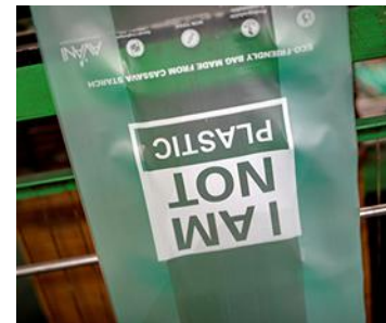
I Avani Ecos fabrik producerar man maniokstärkelse-baserade bioplastpåsar. Påsarna, som är komposterbara, tillverkas på löpande band med texten ”I am not plastic”.
